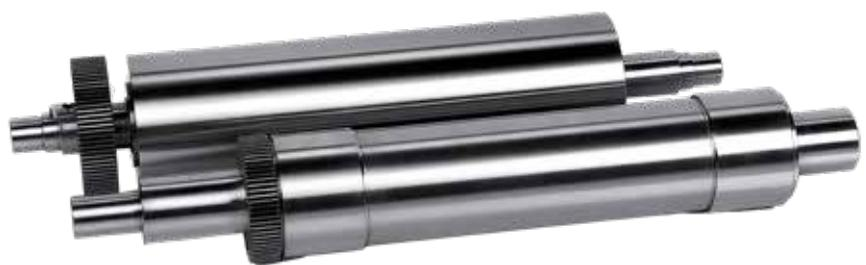
Rotometal liefert Gegenstanzzylinder sowie Stützwalzen aus hochwertigem Werkzeugstahl. Je nach Kundenwunsch können diese induktionsgehärtet oder durchgehärtet werden, bis zu einer Härte von 62 +/- 2 HRC.
